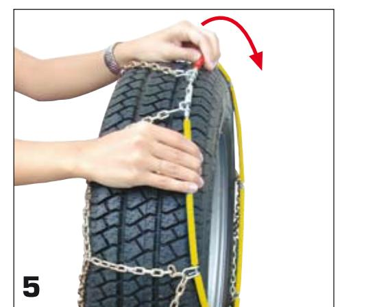
**I** Le immagini 5 e 6 dimostrano come il cavo flessibile in acciaio rivestito in plastica colorata deve essere spinto e posizionato all'interno del pneumatico affinché il montaggio risulti corretto.
