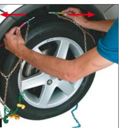
**I** Sganciare il cavo e lasciare cadere la catena a terra. Spostare la vettura quanto basta per togliere la catena da sotto il pneumatico.
