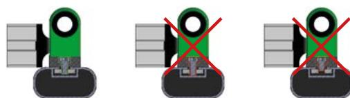
Se questa operazione non fosse possibile è necessario sostituire le viti. Nella confezione Civi 3Axis sono presenti kit viti di lunghezza inferiore:
